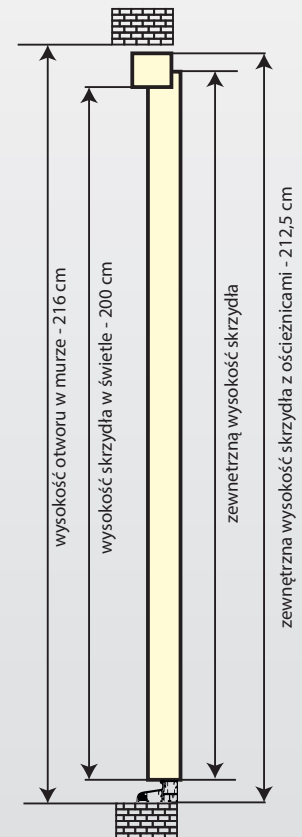
drzwi Energooszczędne (pasywne) grubość 100 mm
